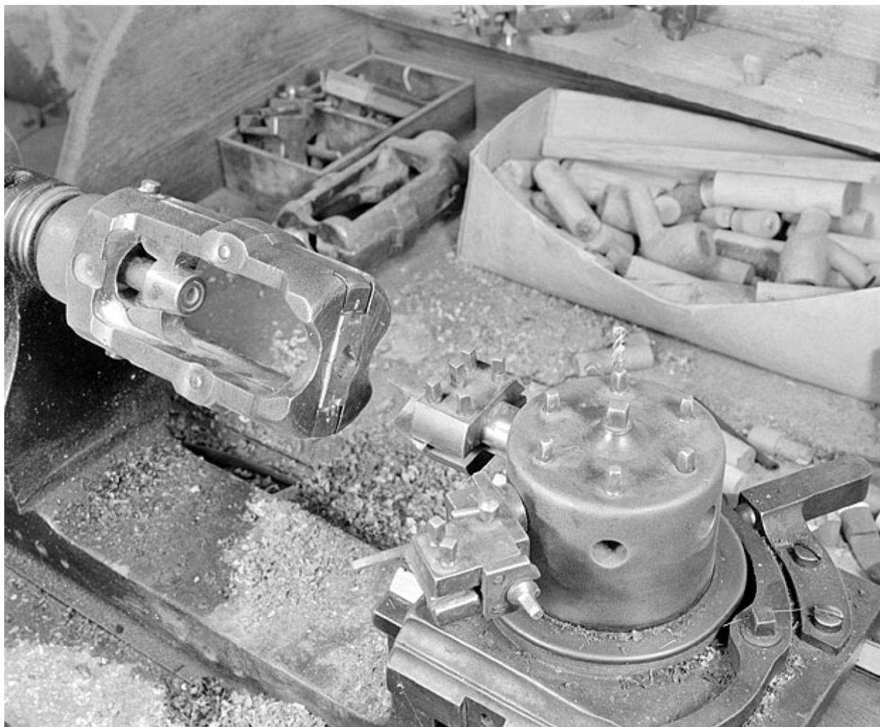
Tour (atelier de finissage). Les mâchoires et le revolver alignés, vus de trois quarts droite.
