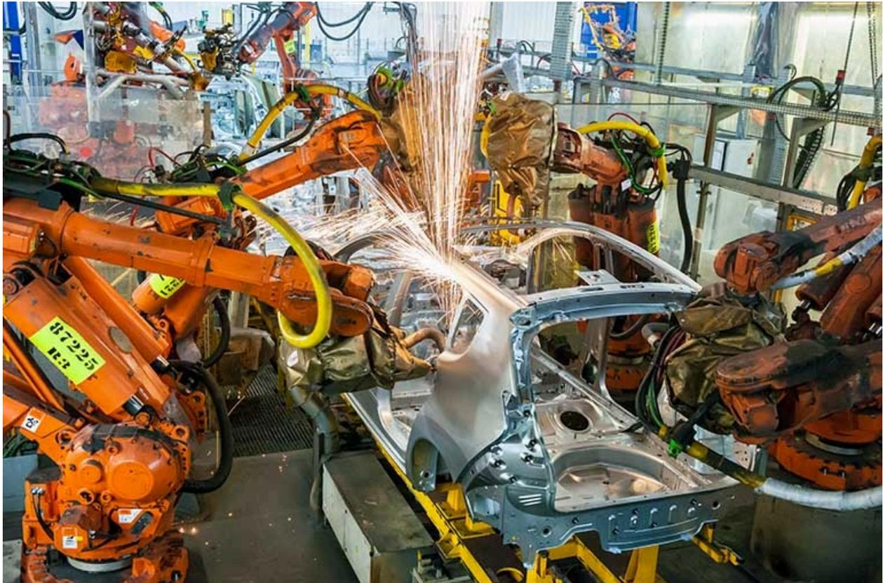
Atelier de ferrage. Robots de soudage sur la caisse en blanc (1).
