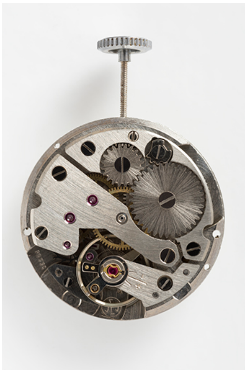
Mouvement Jeambrun PS 33 C : face côté ponts.
