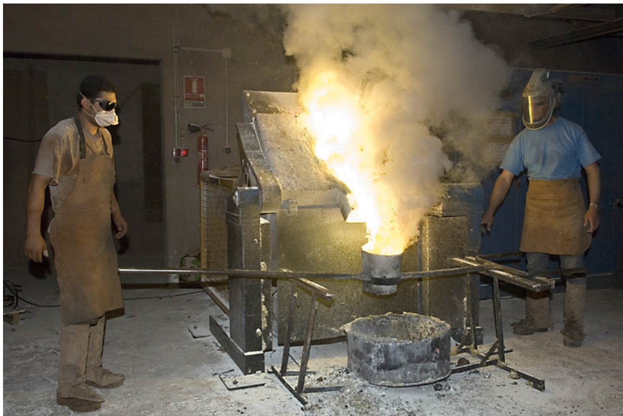
Four électrique. Remplissage de la poche.
