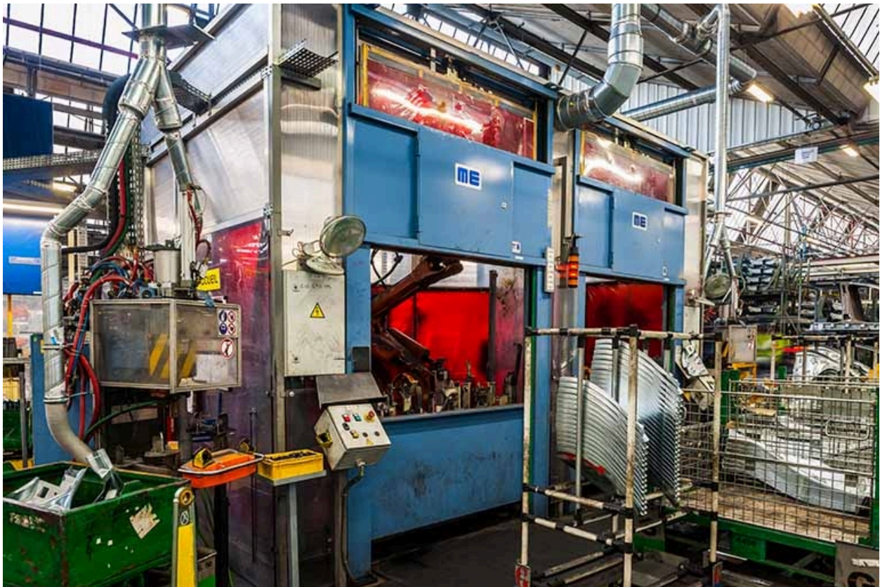
Atelier de ferrage. Admission de pièces dans un îlot robotisé.
