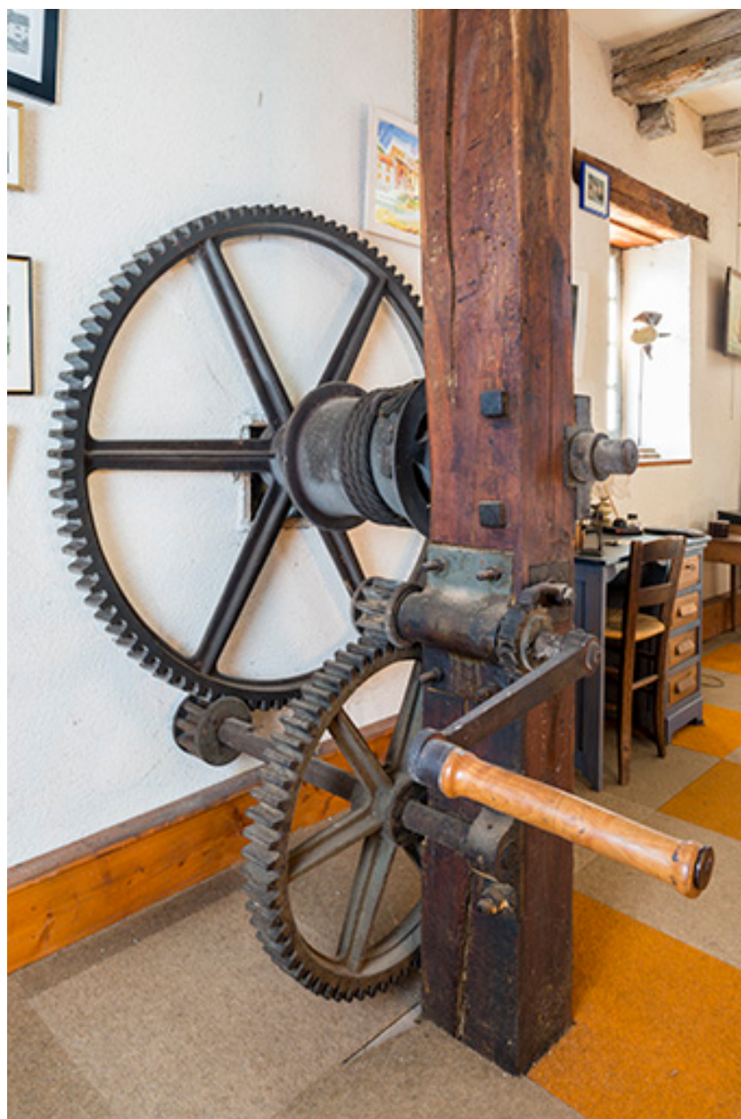
Premier étage. Détail de système de levage de la roue suspendue (amont).
