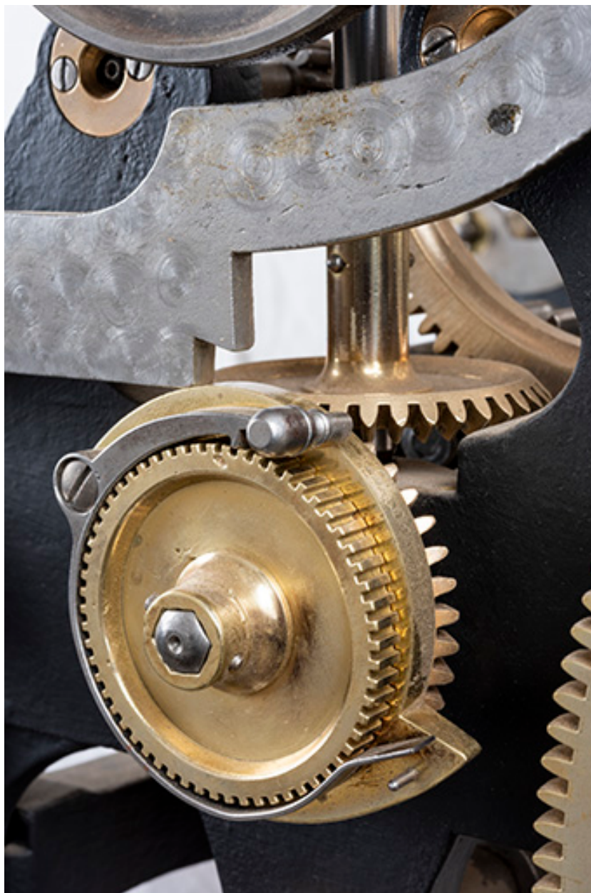
Mouvement, mécanisme des heures : roue dentée et pignons de renvoi.
