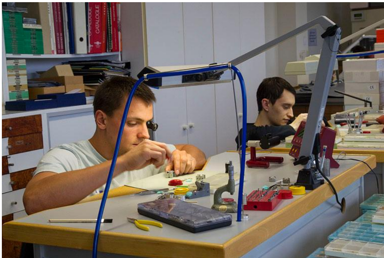
Atelier du service après-vente : réglage du mouvement.
