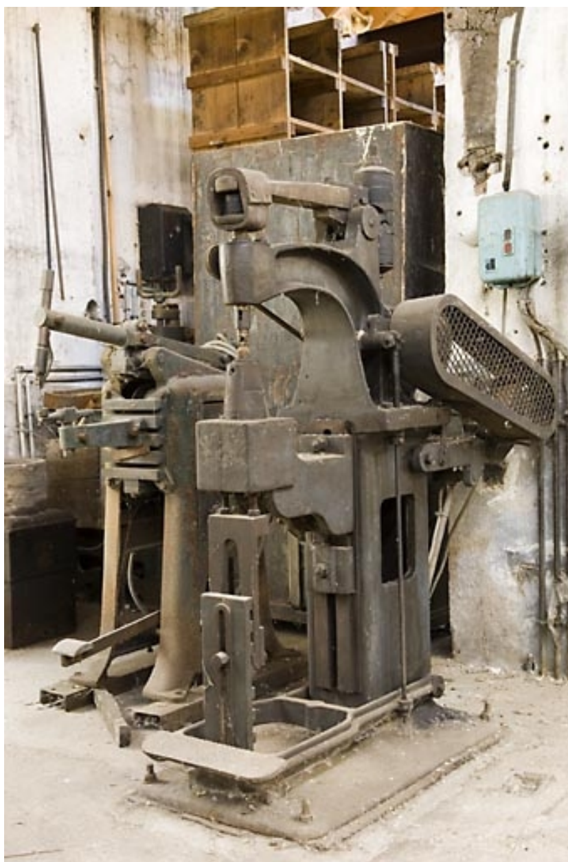
Atelier ouest. Riveteuses Pontelec et Guillemain.
