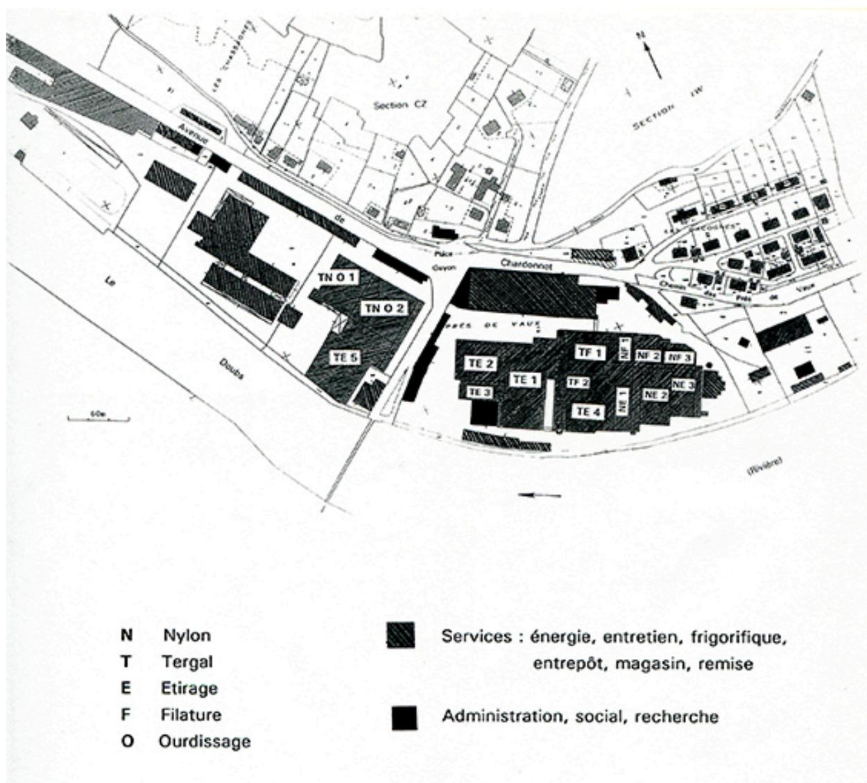
Schéma de répartition fonctionnelle de l'usine. D'après un plan commenté de localisation d'ateliers et de machines, s.d. [vers 1980 ?]. Fonds : plan cadastral, 1982, section DH, 1/1 000 réduit à l'échelle approximative 1/4 000.
