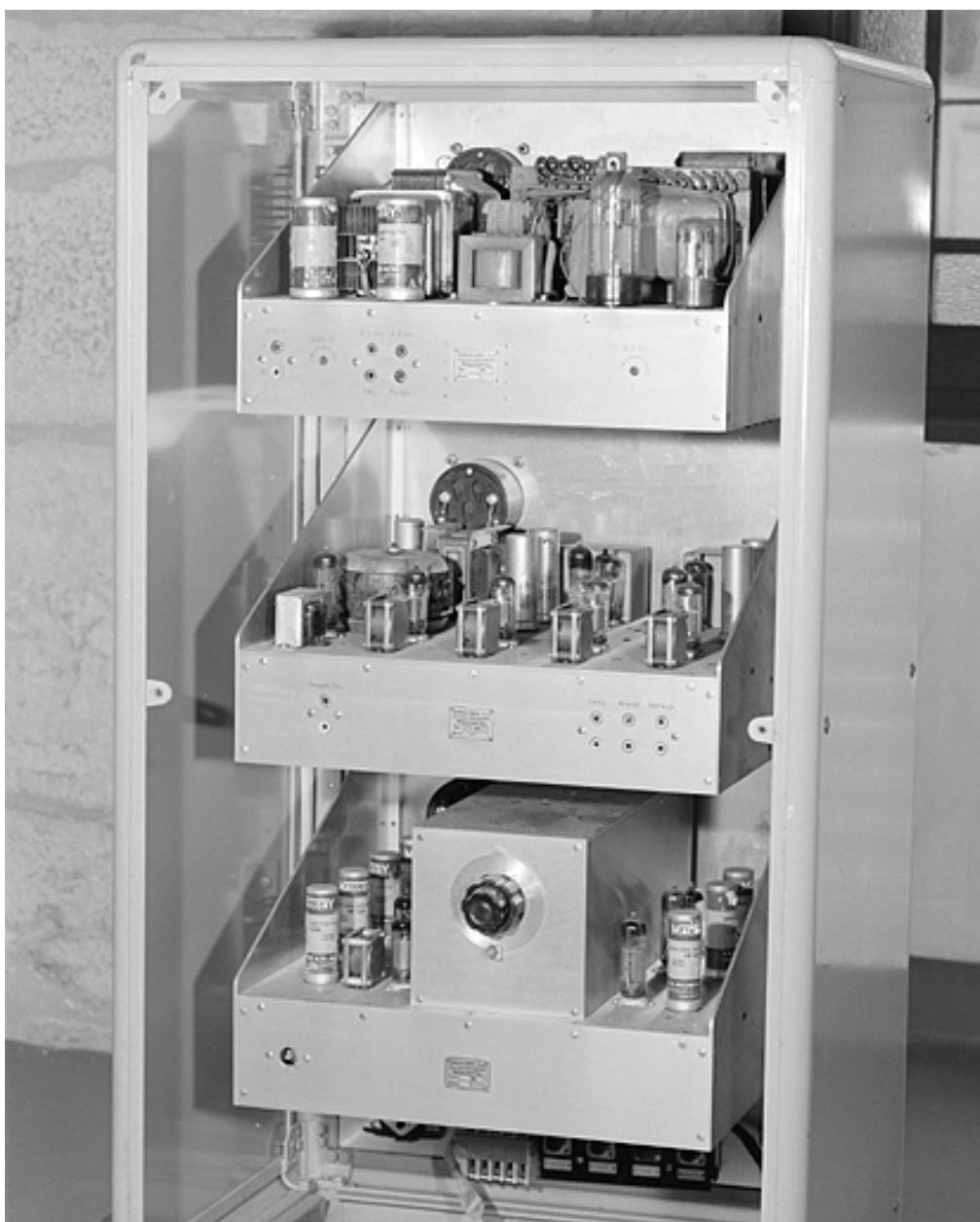
Horloge à quartz n° 24 : face arrière.
