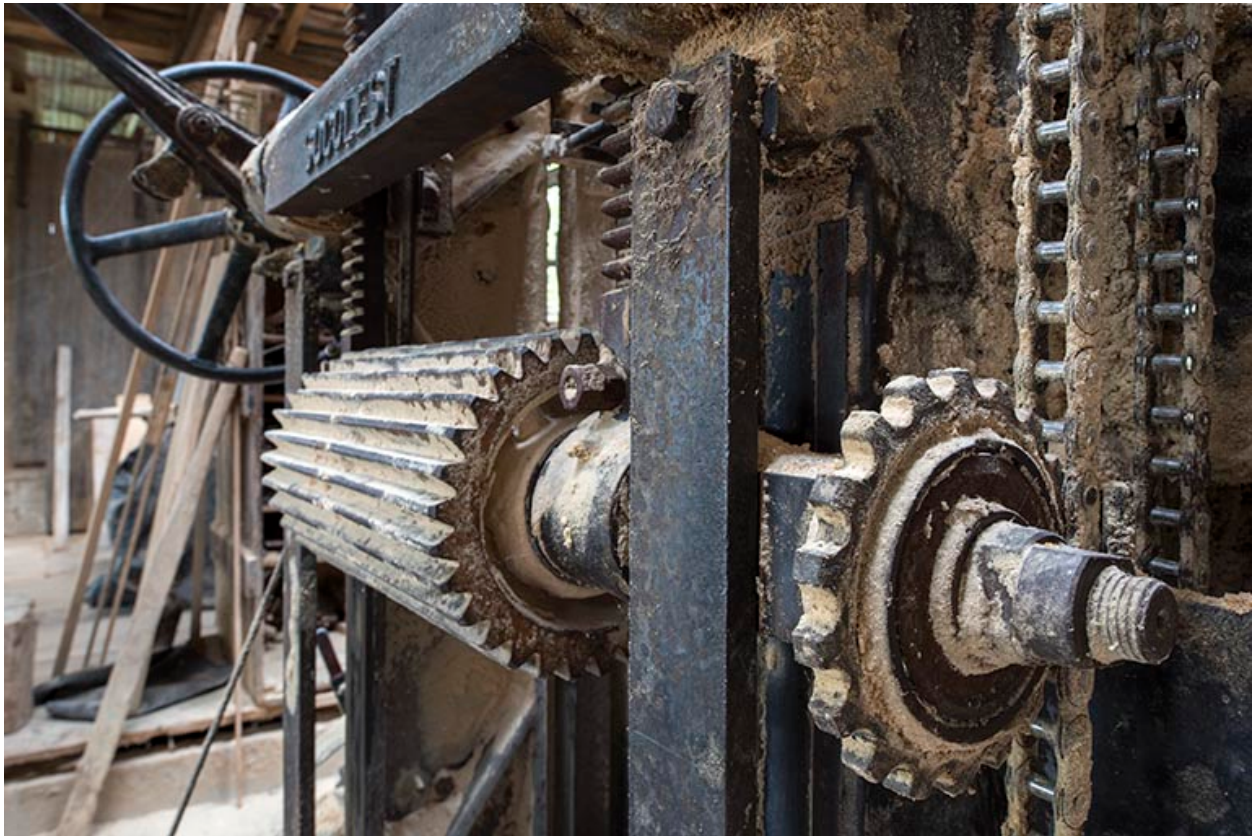
Atelier de fabrication : châssis de scie Socolest, pignon et rouleau.
