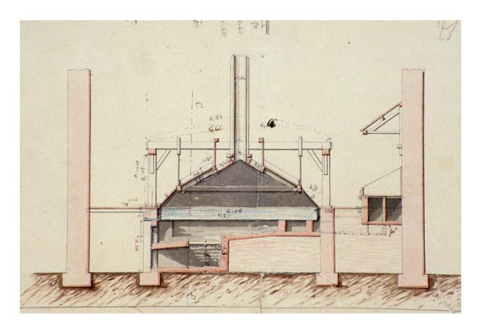
Etablissement de deux nouvelles Poêles. Poêle n° 5 [détail : coupe perpendiculaire aux axes des foyers], 1847.
