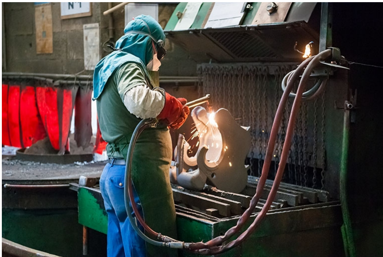
Découpage de pièces au chalumeau (3).
