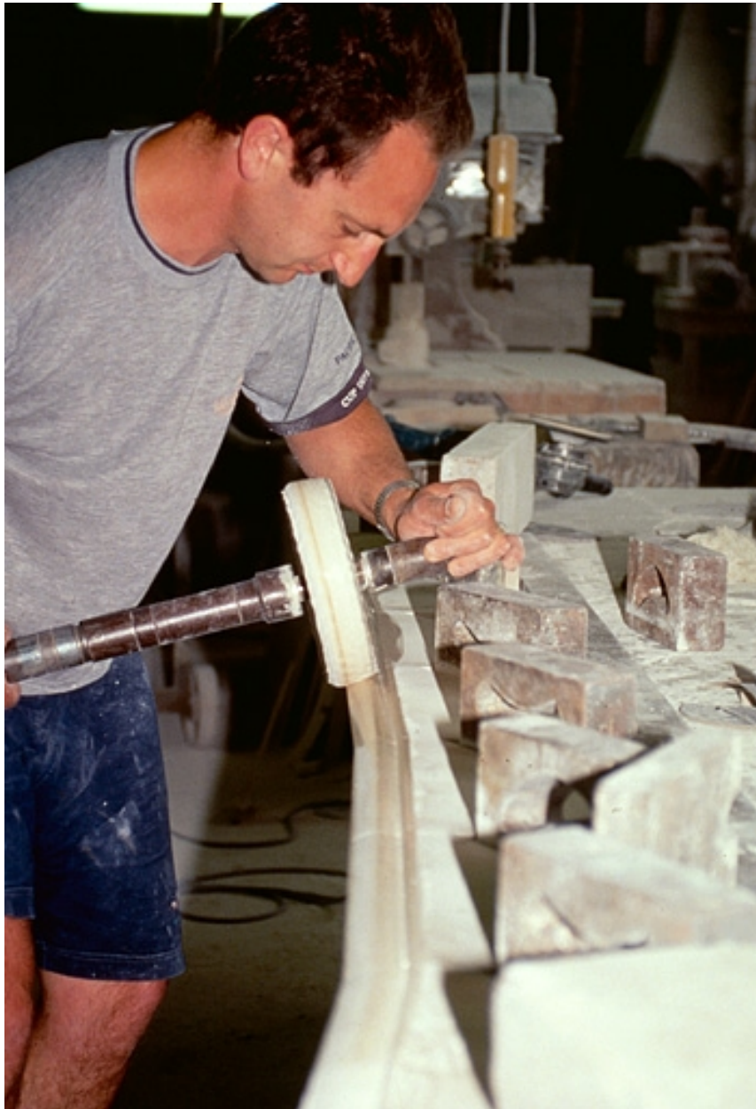
Polissage d'un limon d'escalier.
