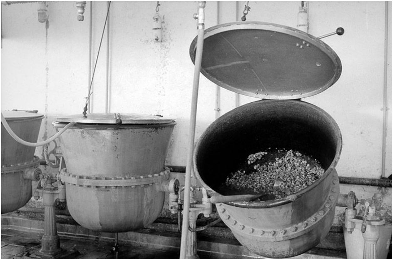
Conserverie Ménétre, atelier de fabrication (3) : marmites de première cuisson.
