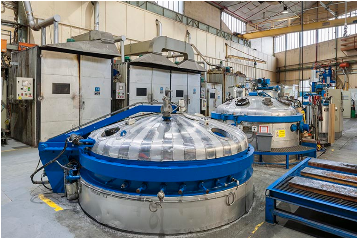
Autoclaves (imprégnation de vernis des stators).
