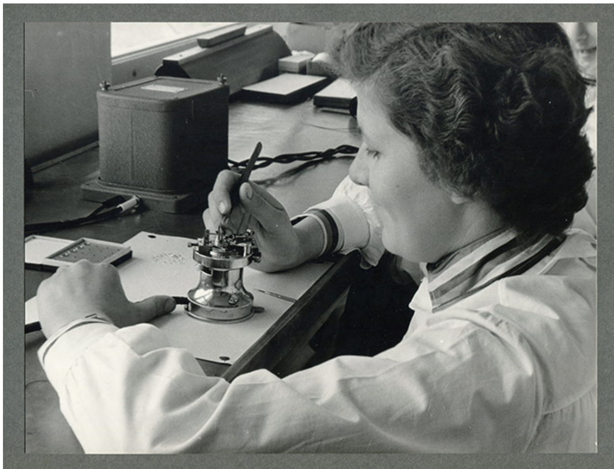
Ouvrière au travail : réglage du balancier-spiral, années 1960.
