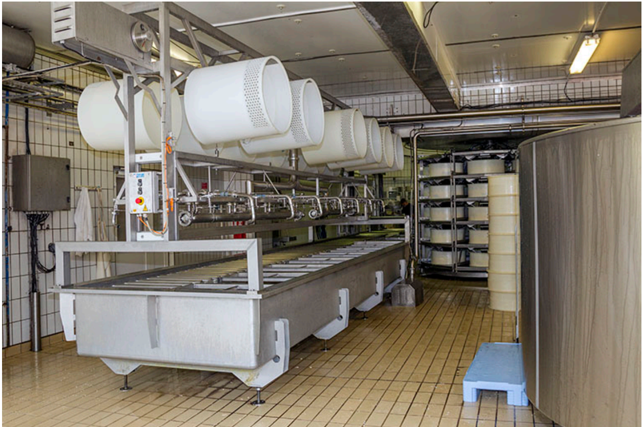
Installation de soutirage par pompe à caillé : le répartiteur. Les rehausses de moulage sont suspendues en partie haute du répartiteur.
