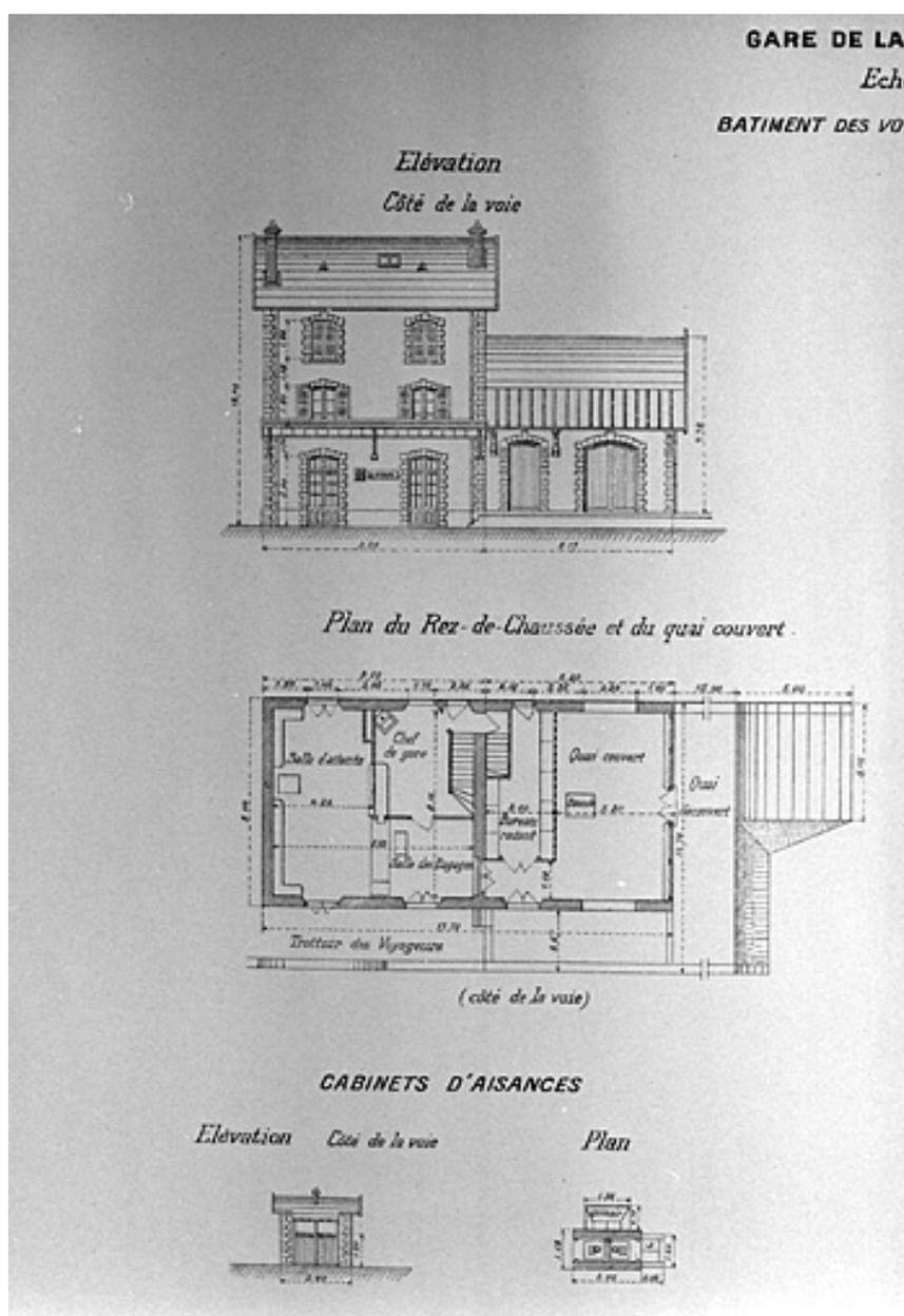
Bâtiment des voyageurs [... Détail partie gauche : plan du rez-de-chaussée et élévation côté voie du bâtiment des voyageurs, plan et élévation des latrines], [1919].
