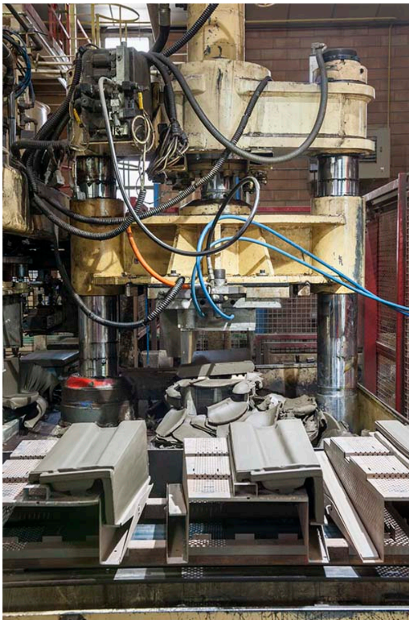
Tuilerie et briqueterie Migeon, à Lantenne-Vertière : unité de fabrication UL 3. Pressage de tuiles de rive.
