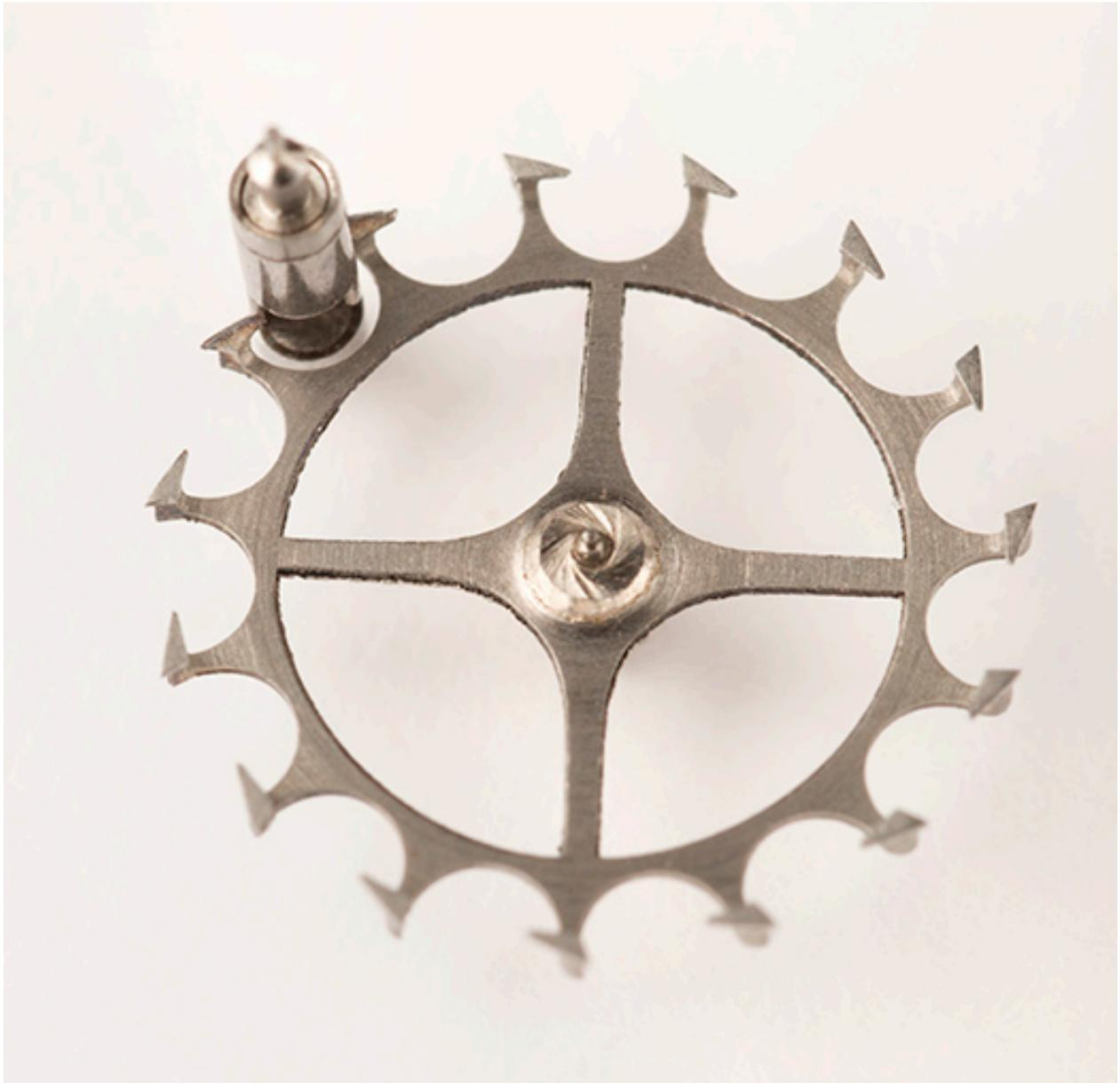
Entrée d'une dent de la roue dans le cylindre.
