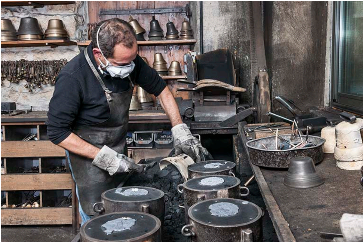
Démoulage. Extraction de la cloche (4).
