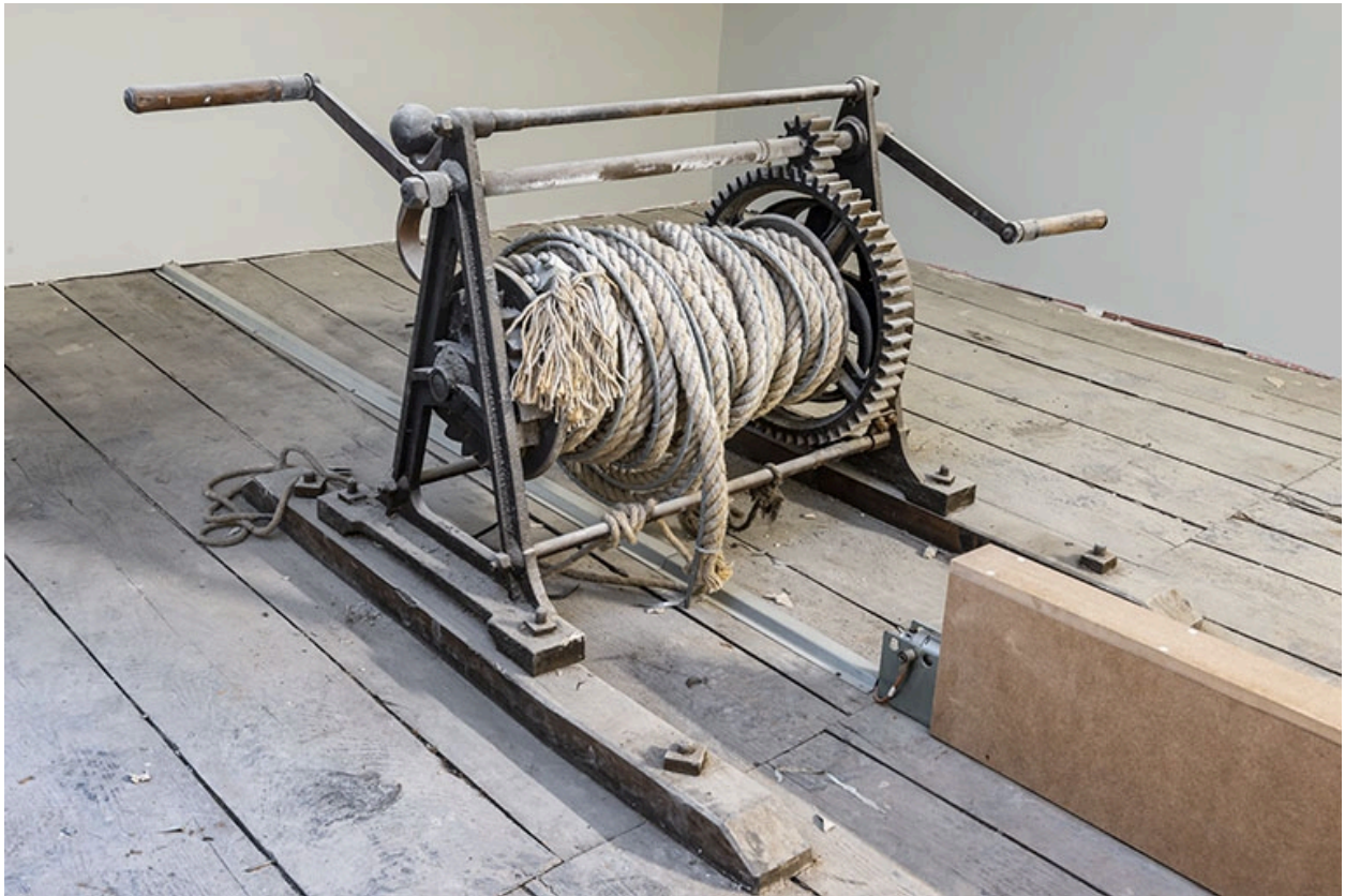
Treuil (désaffecté) du lustre de la salle.
