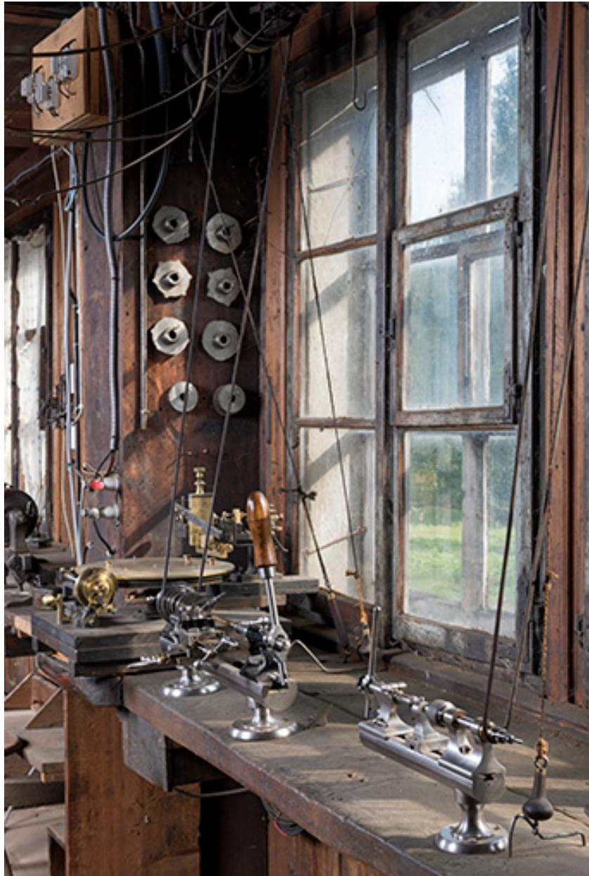
Machines installées derrière la fenêtre multiple : deux tours Lorch et, à l'arrière-plan, une machine à diviser.
