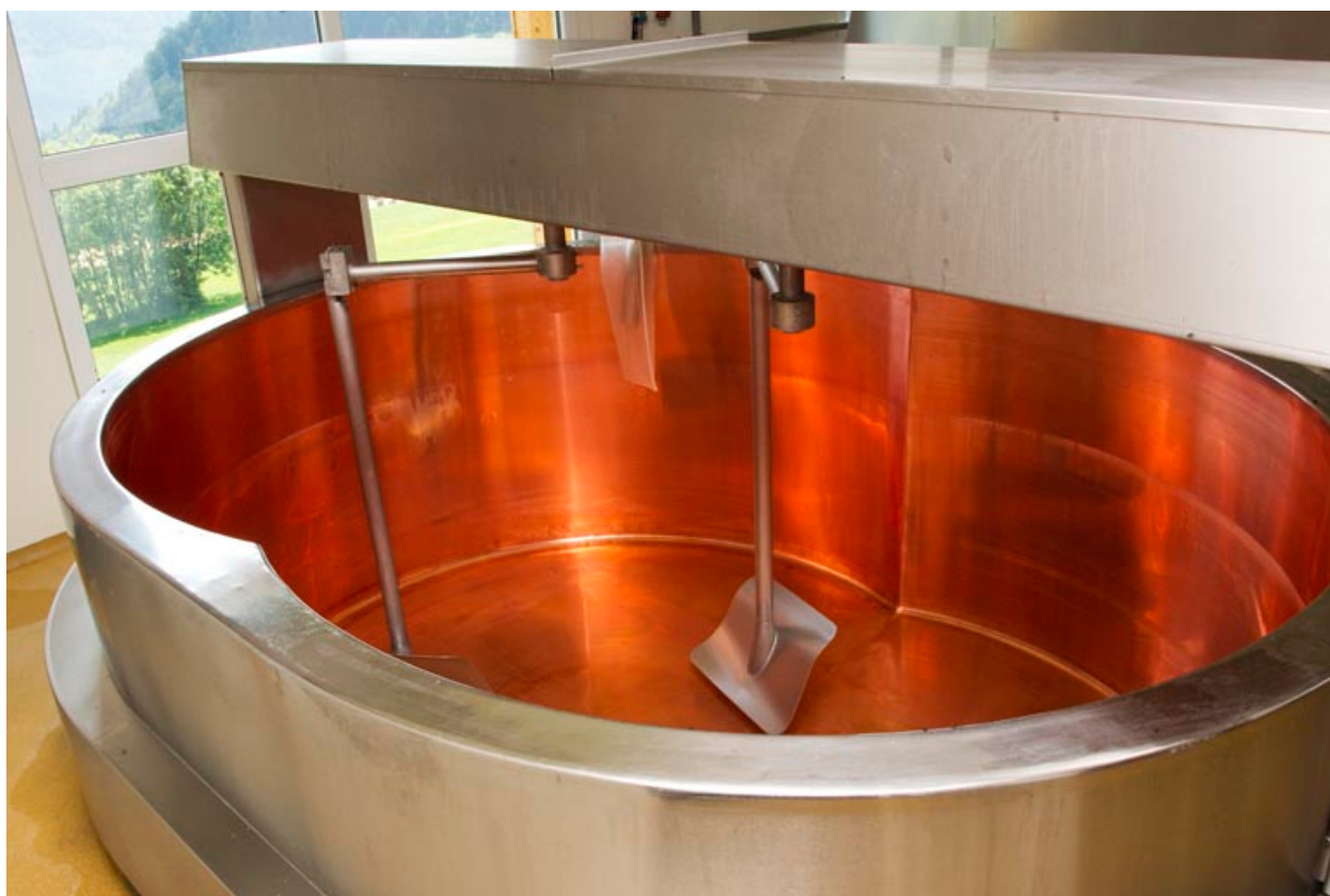
Cuve de fabrication : vue plongeante montrant l'intérieur.
