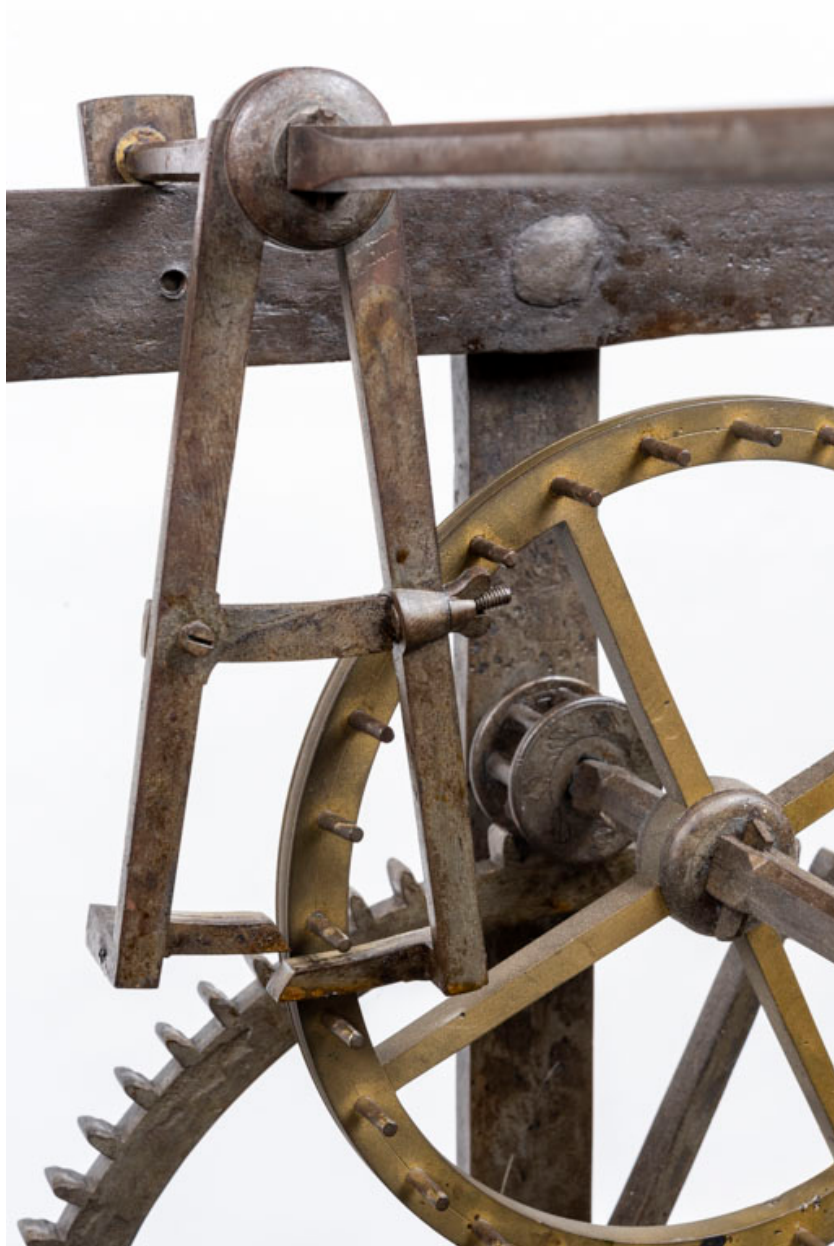
Echappement à chevilles : ancre et roue d'échappement.
