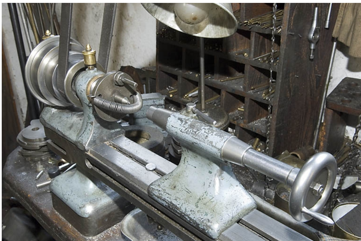
Tour horizontal Waltham (B). Détail de la poupée fixe et de la poupée mobile.
