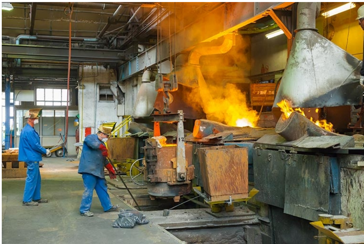
Fours à induction. Préparation d'une coulée.
