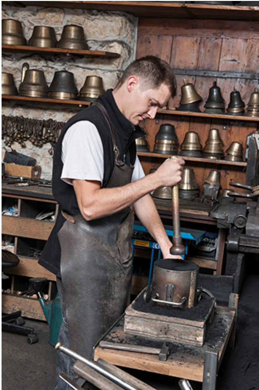
Moulage. Tassage au fouloir métallique (2).
