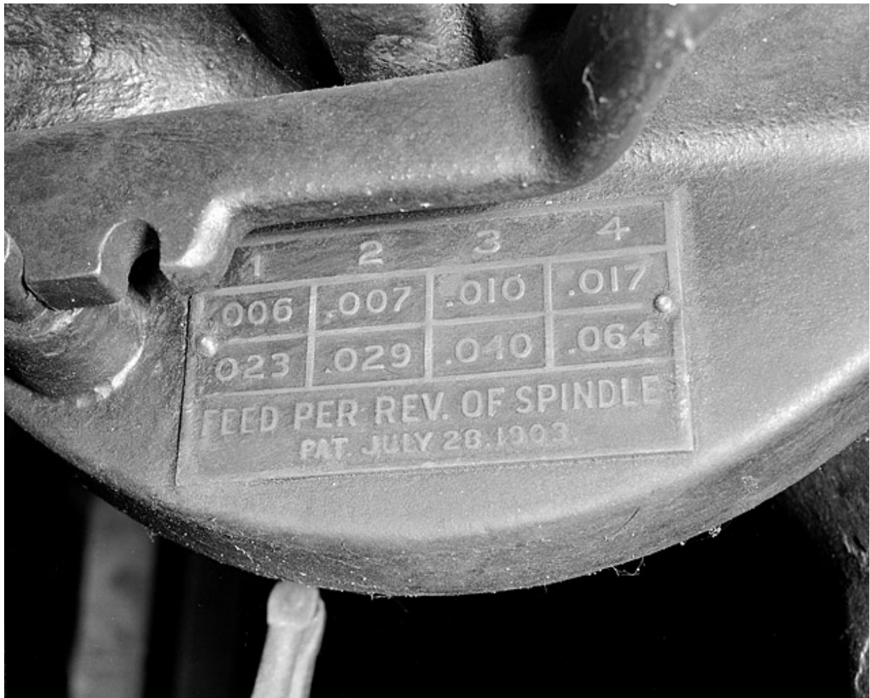
Détail de la plaque de la boîte de vitesses.
