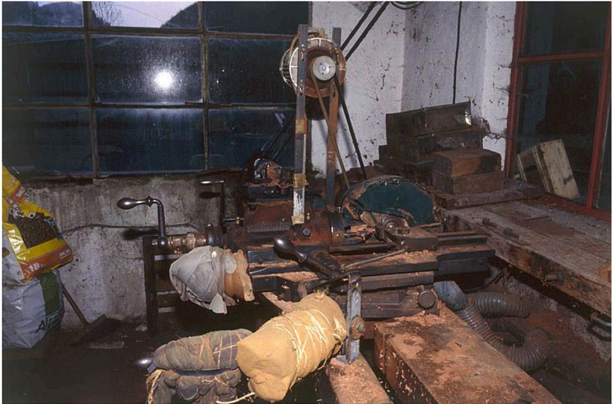
Machine à fraiser dite machine à aplatir.
