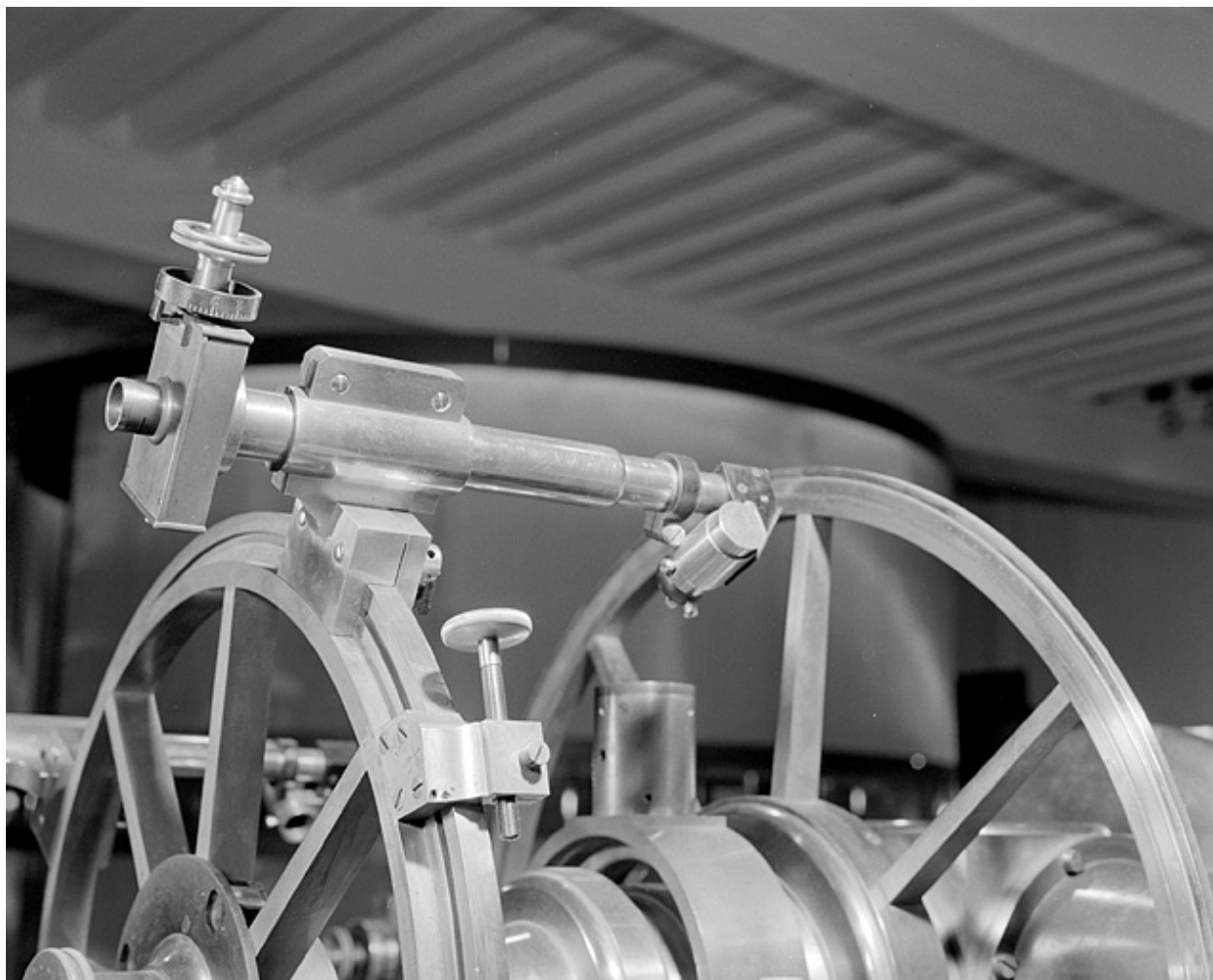
Altazimut : détail du système de réglage et de lecture du cercle.
