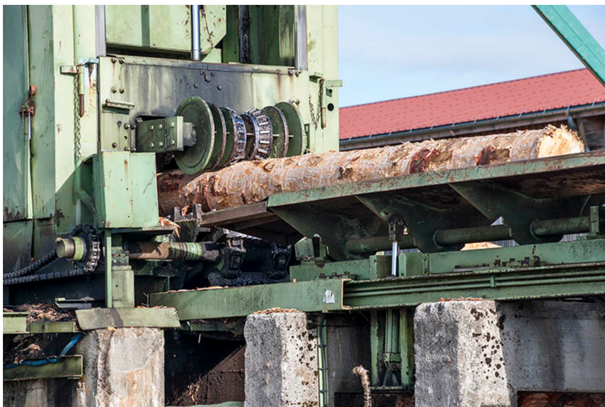
Détail du poste d'écorçage.
