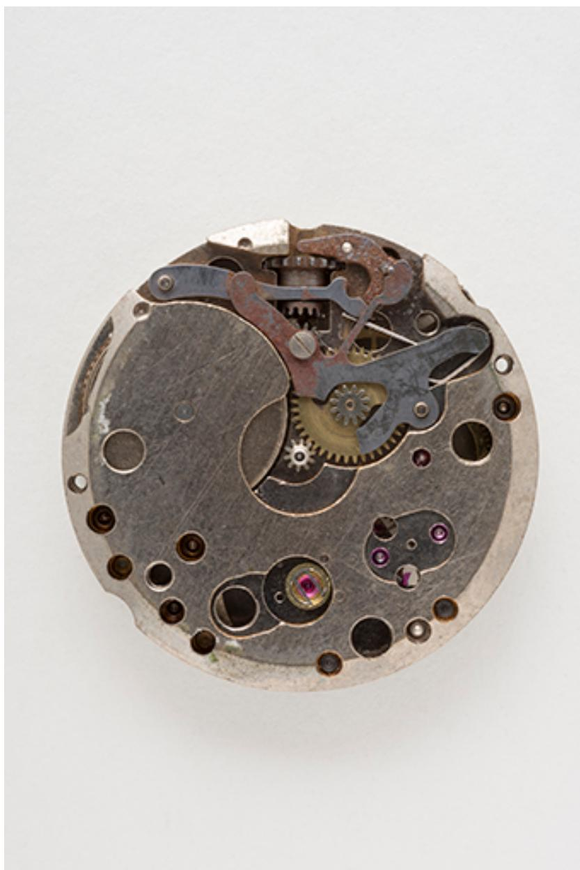
Mouvement Cupillard 233-60, vu côté cadran.
