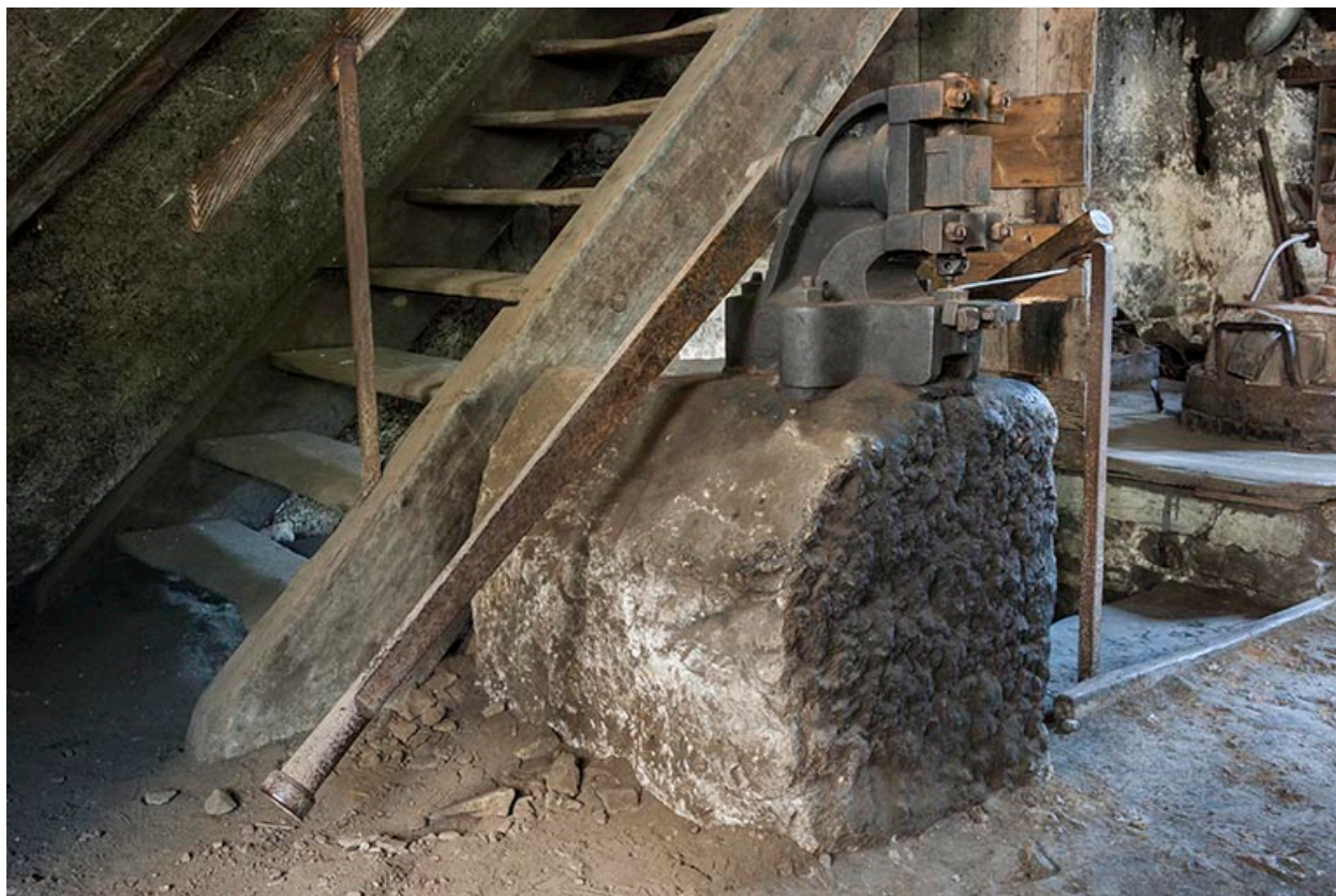
Atelier de mécanique. Poinçonneuse.
