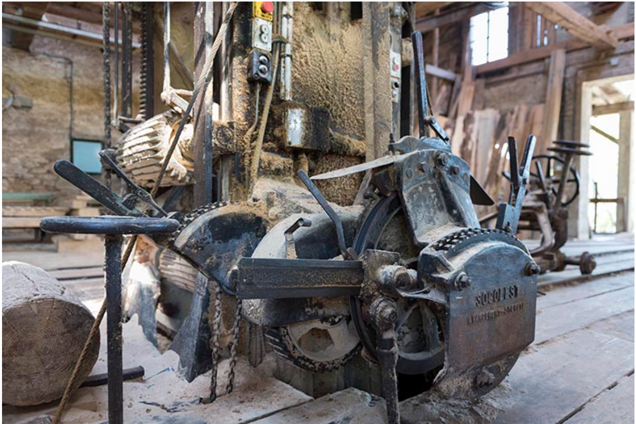
Atelier de fabrication : châssis de scie Socolest, détail du système moteur.
