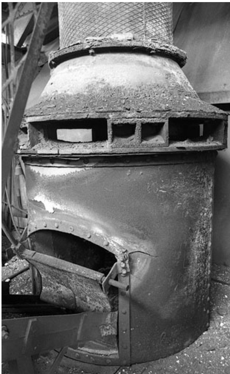
Gueulard (partie supérieure) du grand cubilot (5 tonnes).
