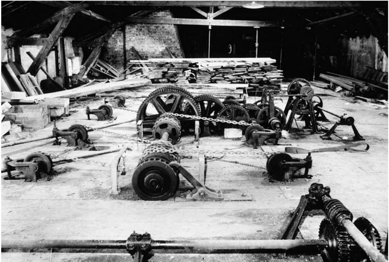
Système de descente à chaînes (châssis 1 et 2).
