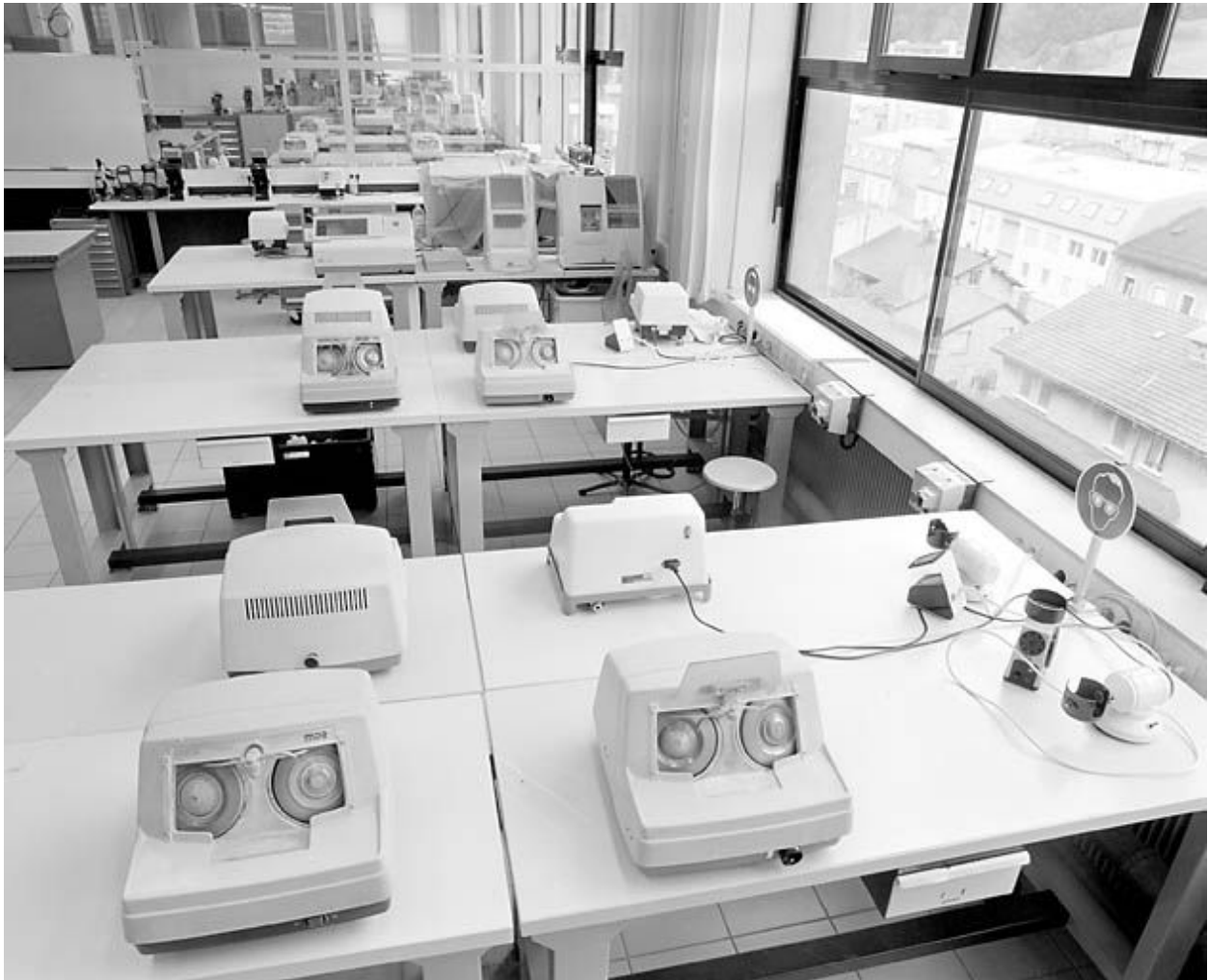
Bâtiment B, optique-lunetterie : ensemble de machines à déborder.
