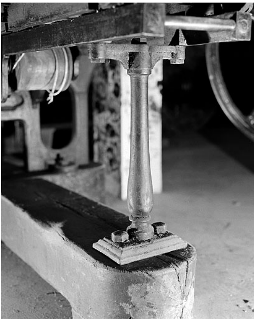
Détail du pied soutenant les rails du chariot.
