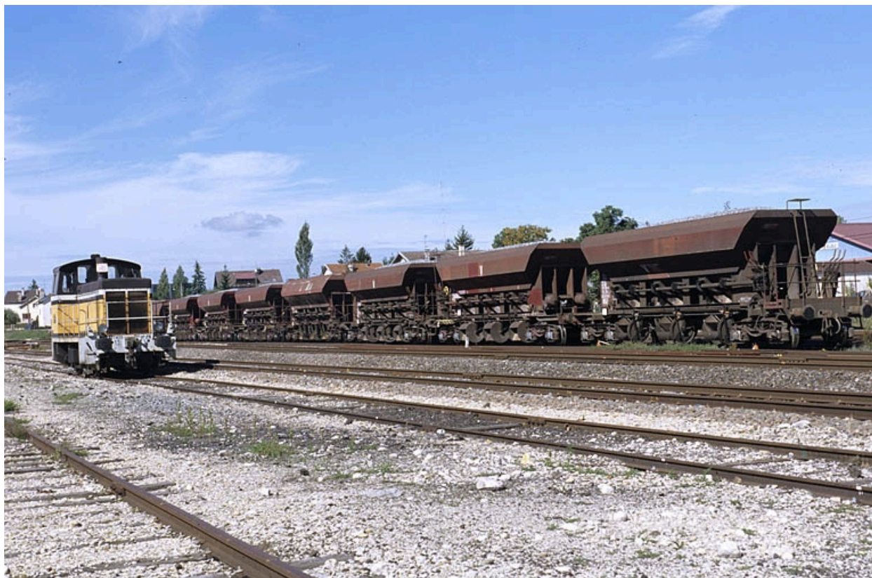
Locomotive diesel Y 7400 (n° Y 7435) et wagons-trémies.
