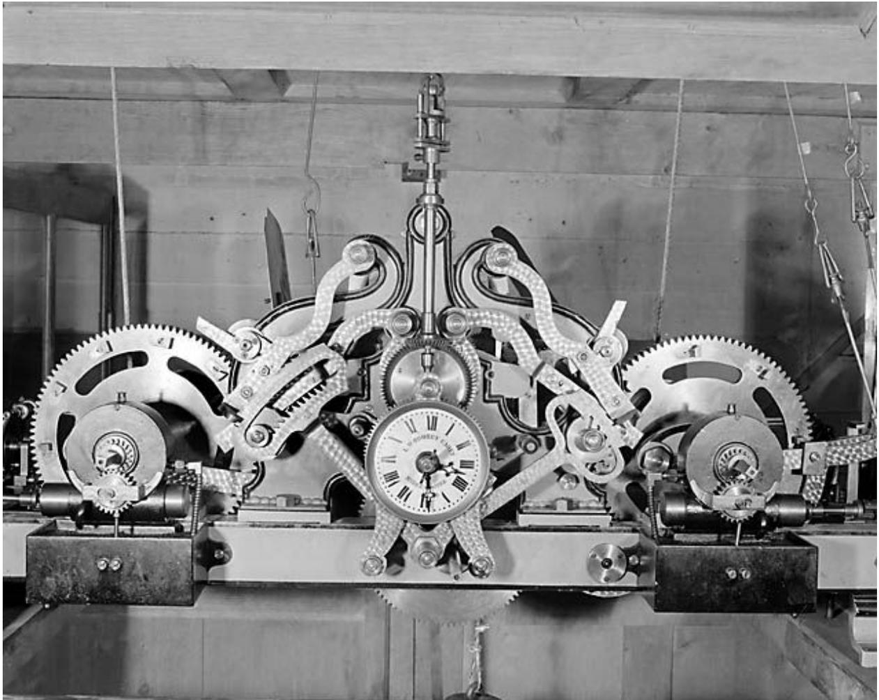
Le mouvement. Système de sonnerie à râteau (placés en biais, les deux râteaux encadrent le cadran de contrôle), avec sonnerie des heures à gauche et des quarts à droite.
