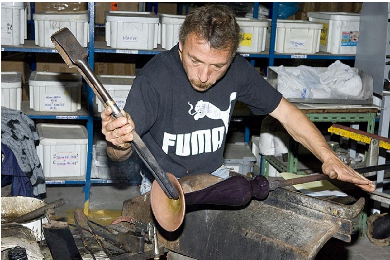
Verrerie de la Rochère : façonnage du pied d'une lampe.
