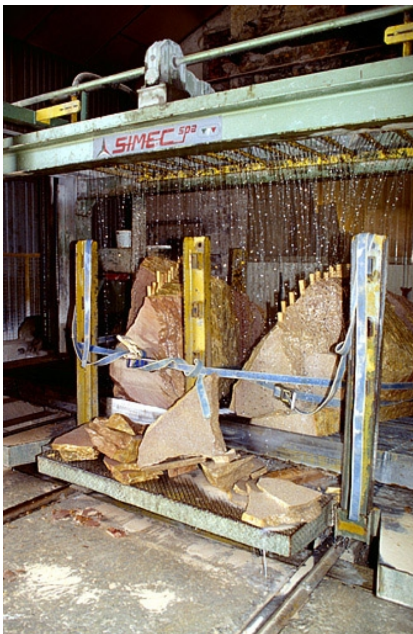
Usine de taille de matériaux de construction Yelmini Artaud, à Balanod : châssis multilames Simec.
