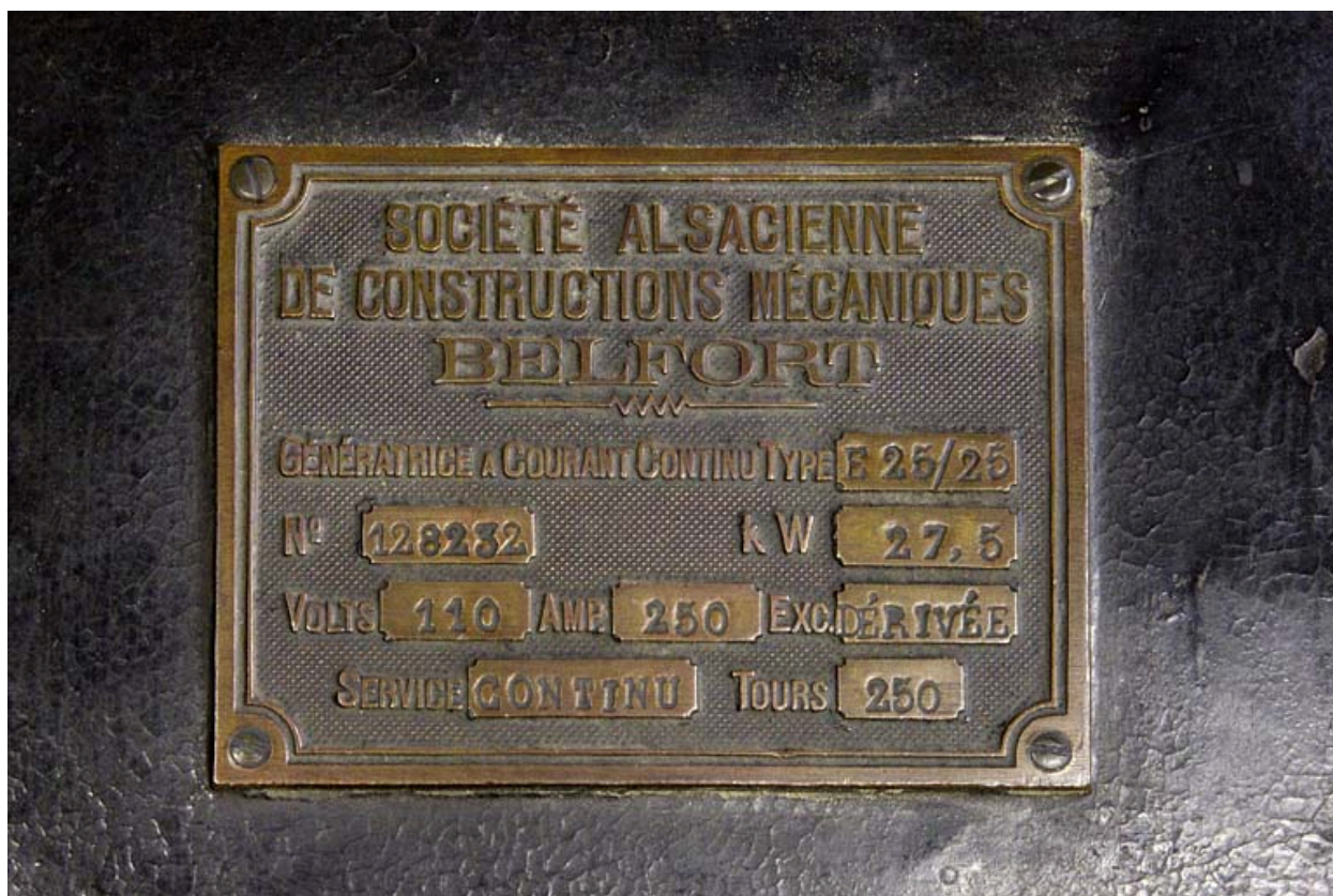
Centrale : plaque signalétique de l'excitatrice.
