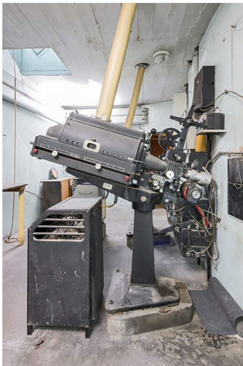
Projecteur côté cour et son redresseur.
