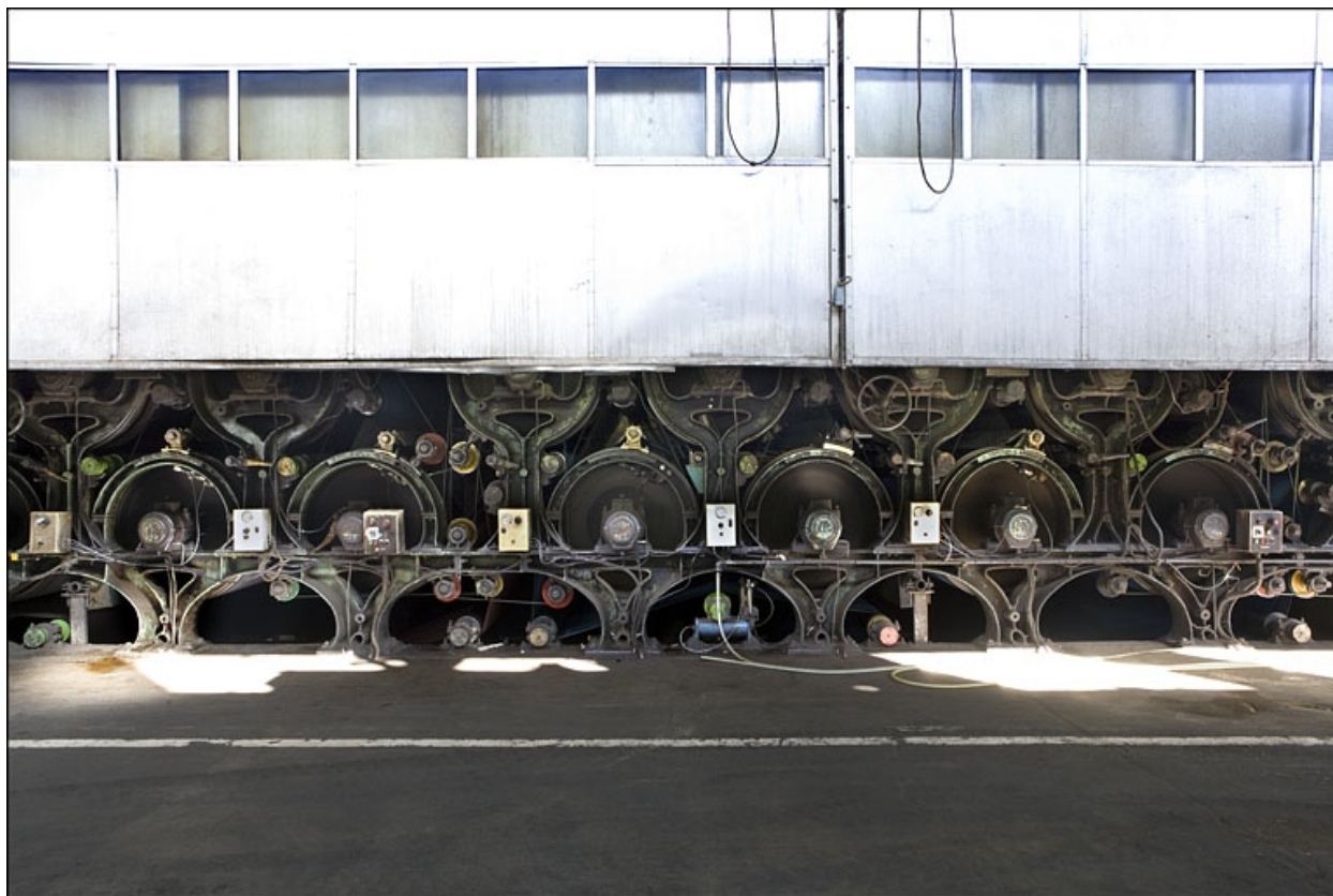
Machine à papier. Le calandrage.
