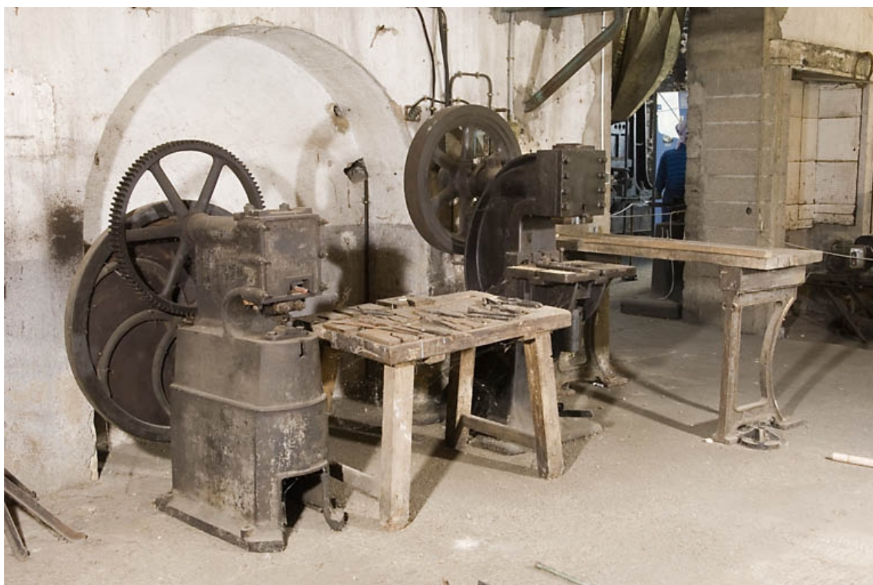
Atelier ouest. Poinçonneuses.
