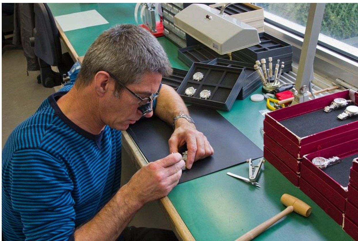
Atelier de fabrication : pose du bracelet.
